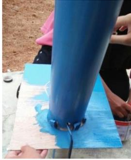
Cara menggunakan alat pendeteksi ini adalah, *per-tama* letakkan alat pendeteksi banjir kedalam bak, *kedua* colokkan kabel kedalam stop kontak sehingga alat dalam keadaan on, *ketiga* masukkan air kedalam bak sehingga sterofom akan naik dan kayu akan mengenai seng pada saat itu bel dan lampu akan menyala secara bersamaan yang menandakan bahwa debit air naik.
