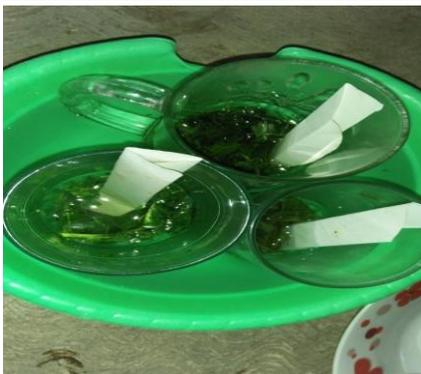
Isi gelas dengan alkohol hingga menutupi permukaan daun yang sudah dihaluskan dan tuangkan air kedalam baskom atau nampan yang sudah berisi gelas, tunggu hingga terjadi perubahan warna pada kertas saring (30-60 menit).
